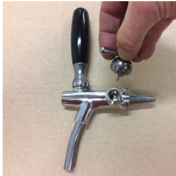
2. Irroita virtaussäätimen vipu kiertämällä sen lukitusmutteri auki.
